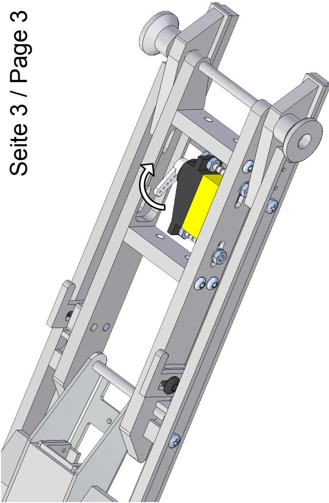
In Abhängigkeit von der Einbaulage ändert sich die Laufrichtung des Servos.
