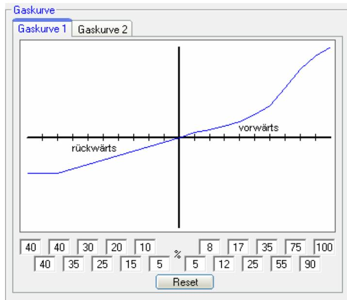
Durch einen Klick auf „Reset“ wird die Gaskurve wieder auf einen linearen Ausgangswert gesetzt.
