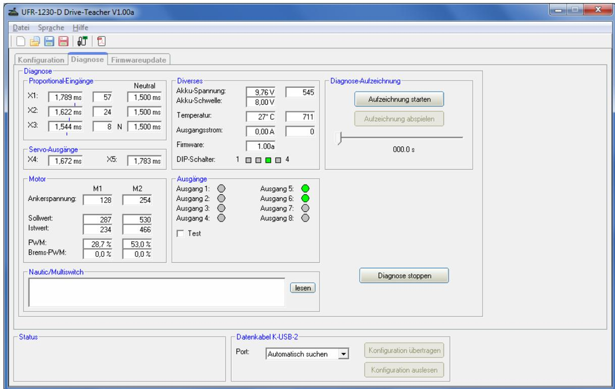
Im Drive-Teacher ist eine Diagnosefunktion integriert, mit deren Hilfe verschiedene Funktionen des Fahrtreglers überprüfen kann. Dazu muss das Datenkabel [K-USB-2](#) an den Fahrtregler an X6 angeschlossen werden.
