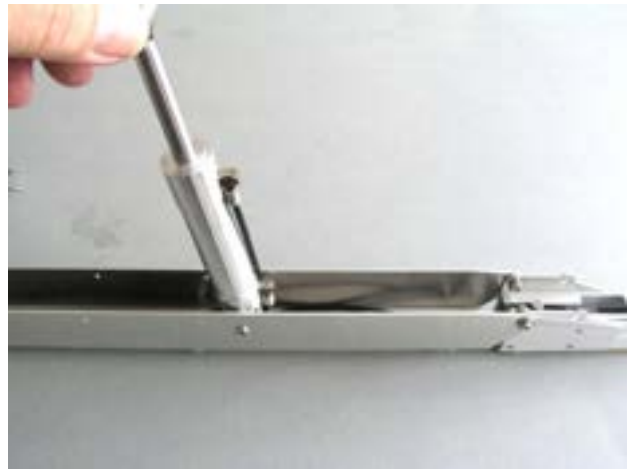
Der Hubzylinder des 3.Arms wird mit 160cm Schlauch H052 verschlaucht , der vorher durch die Schlauchhalter geführt wurde .
