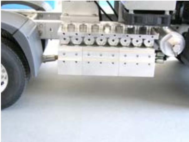
Angeschraubtes Ventil am Wedico-Rahmen .
