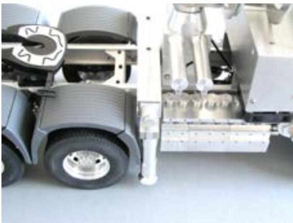
Hinter dem Kranhalter wird die Abstützung auf dem Rahmen befestigt .
