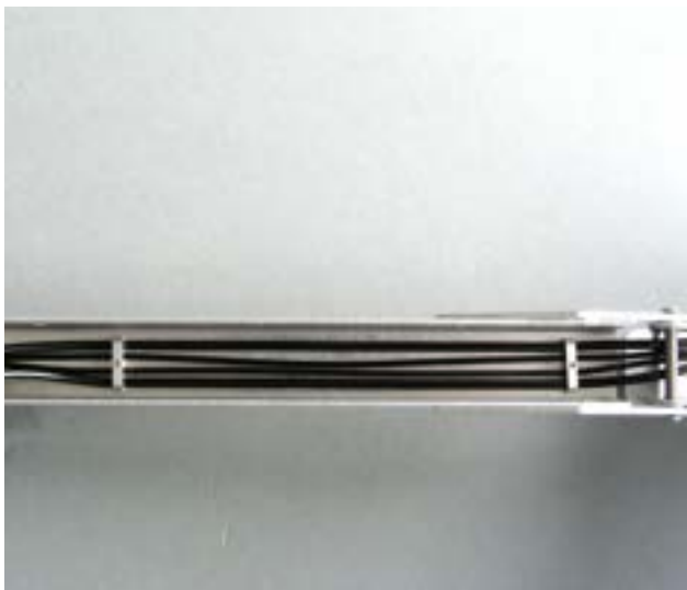
Das nebenstehende Bild zeigt die Schlauführung .
