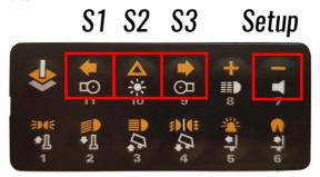
Die Sendeleistung kann über die Setuptaste (rechts oben) und Blinker links (klein), Warnblinker (mittel), Blinker rechts (groß) eingestellt werden und über die LiveDaten Ansicht des ControlPanels geprüft werden.
