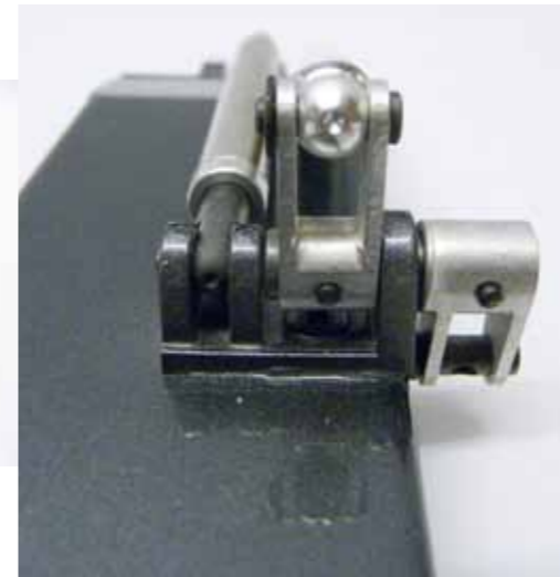
Zug- und Druckfederzylinder dürfen auf keinen Fall vertauscht werden
