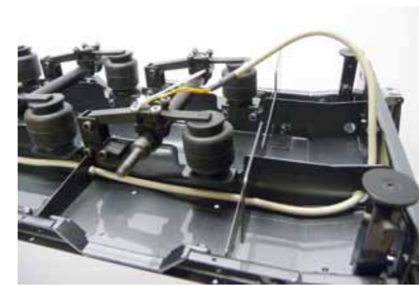
Die passenden Bohrungen im Rahmen erleichtern das Verlegen des Hauptkabels des Beleuchtungssets
