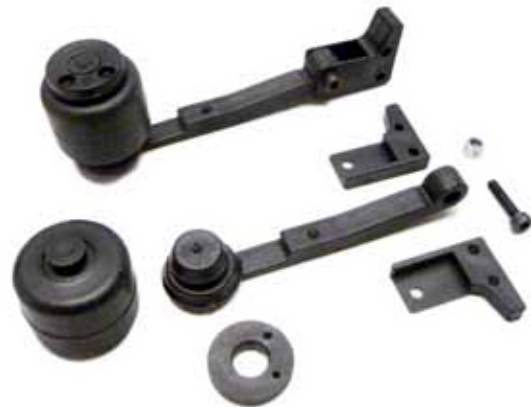
Die original aussehenden Achsträger mit ihren recht weichen Luftfederbalgattrappen werden aus Kunststoffteilen zusammengesetzt
