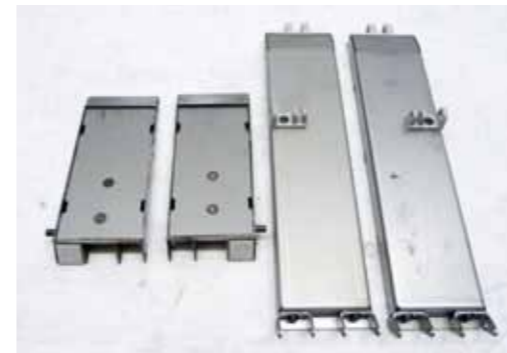
Die Auffahrrampen sind in ihrer Grundform bereits vorgefertigt. Es müssen noch die Gelenkteile angebracht werden
