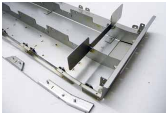
Die Schmutzfänger sind als Blech gestaltet bereits mit dem Rahmen verbunden
