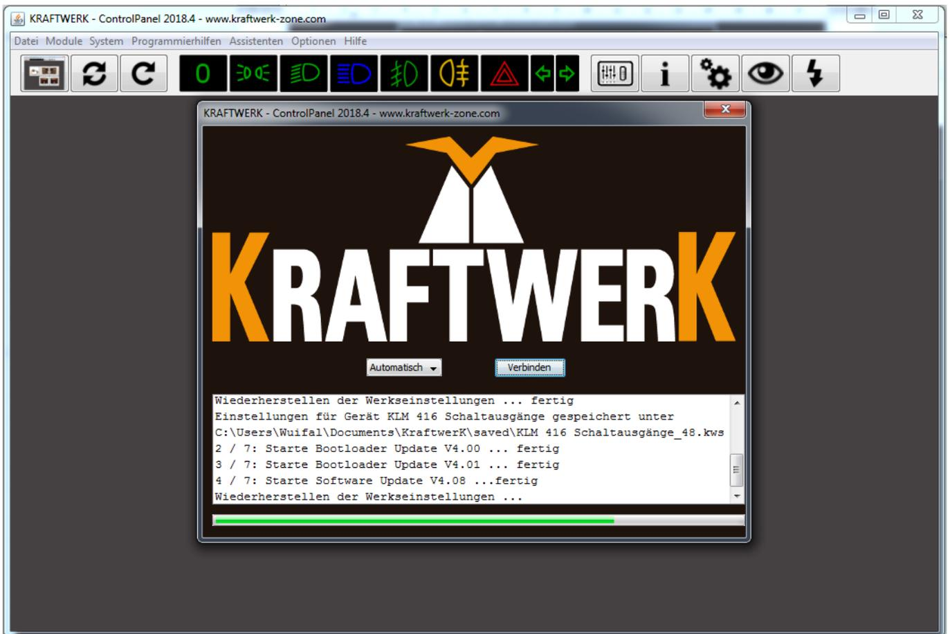
Nachdem alle Updates durchgeführt wurden, werden alle angeschlossenen Module angezeigt. Der KLM 4/16 teilt sich in das Hauptmodul mit den vier Servoausgängen und in die integrierte Schalterweiterung mit den 16 Schaltausgängen.
