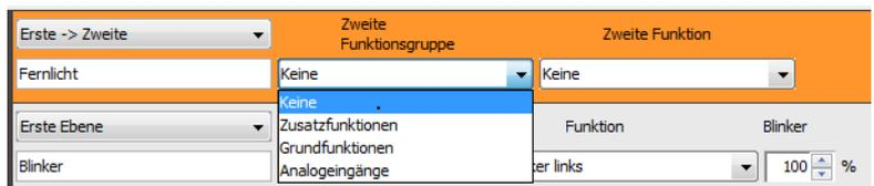
Unter *Zweite Ebene* kann wie gewohnt eine Funktion eingestellt werden, z.B.: Stroboskop auf Grundfunktionen → Warnblinker.
