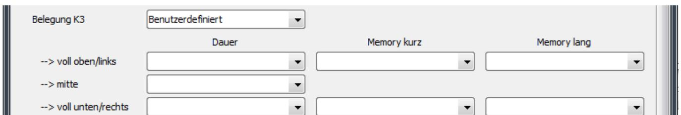
„Dauer“ bedeutet so lange der Knüppel in der entsprechenden Stellung ist, bleibt die Funktion aktiv. Verlässt der Knüppel die Stellung, wird auch die Funktion wieder abgeschaltet.
