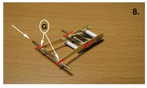
${f G}=$  hier kleben oder löten / glue here or solder;  ${f B}=$  hier biegen / bend here
