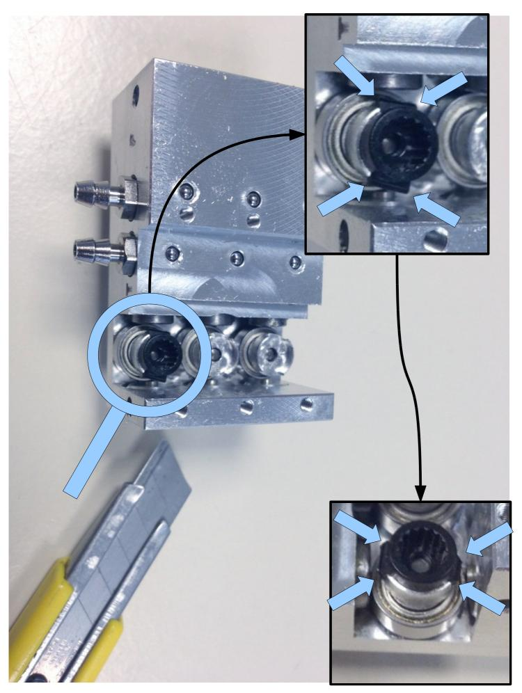
Entgraten bzw. brechen Sie bitte die Kanten des Servo-Hebels an den gezeigten Stellen, damit diese später nicht das Servo behindern, wenn dieses den Exzenter dreht.
