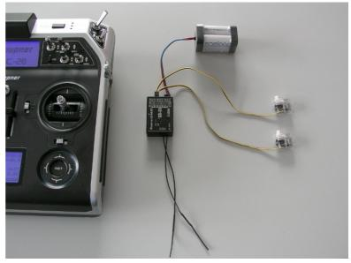
Die Servos müssen daher <u>vor dem Einbau</u> in das Steuerventil, durch anschließen an die jeweiligen Empfänger-Ausgänge Ihrer Fernsteuerung, einmal wieder in die "Neutralstellung" gebracht werden!
