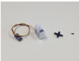
Entfernen Sie bitte zuerst die Schraube in der Mitte und das vom Hersteller vormontierte Servo-Kreuz.
