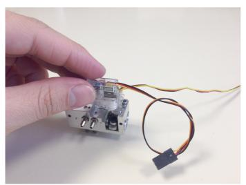
Anschließend können die Servos in die zuvor montierten und gekürzten Servo-Hebel im Ventil eingesetzt und mit den beiliegenden Schrauben DIN-7985 M2 x 4mm fixiert werden.
